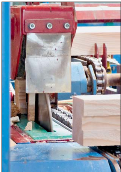
Die im letzten Jahr installierte und 2013 in Betrieb genommene Sortieranlage verfügt über eine automatische Trimmsäge. Die dort anfallenden ...
