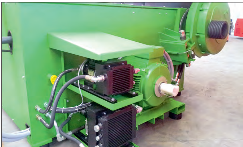
Getriebe und Schieberkühler des „EZ 15/2“
